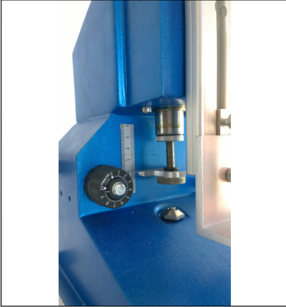
Mengeneinstellung und Geschwindigkeitsregulierung volume setting and speed setting
